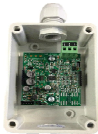
Sonda con sensor Desmontado
