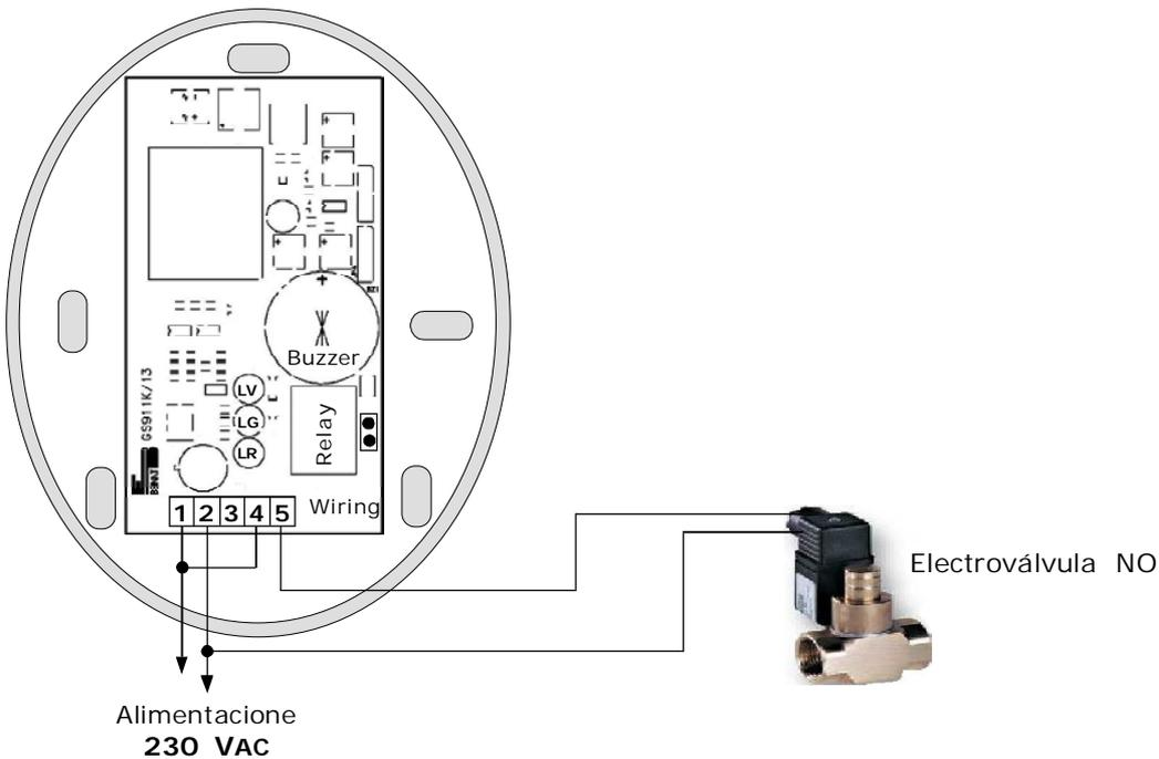
Detector con una o más sondas y una válvula normalmente **abierta** a 230V.
