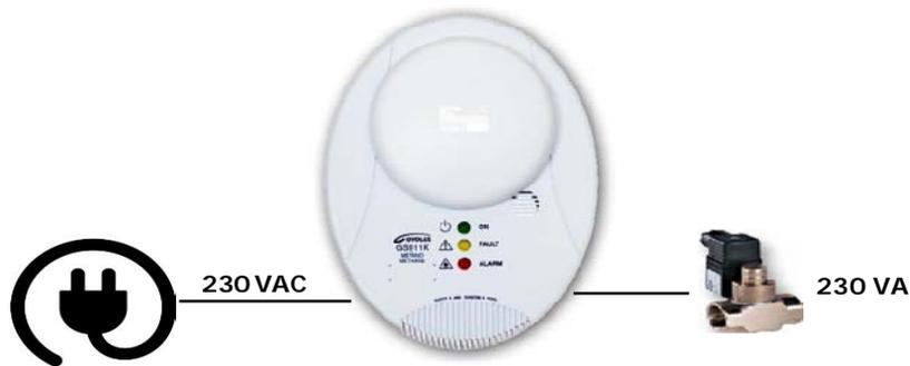
El **GS911K** mediante del sensor **catalítico**, detecta la presencia de gas explosivo, como **Metano y GLP** con un margen de intervención medida al 10% del **LIE**, y puede accionar mediante el relé incorporado, electroválvulas, sirenas y cualquier otro aparato de señalización o alarma.
