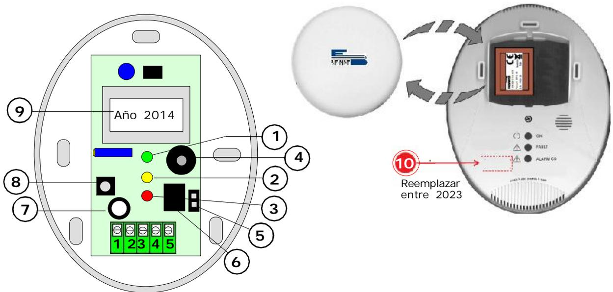
1) Led de señal de funcionamiento incluida. El **GS911K** realiza el control desempeño de los Estados de eficiencia del sensor y lo pondrá a la temperatura en ejercicio. Esta fase dura unos 60 segundos al término de los cuales el led dejará de parpadear, y quedará la luz verde fija.
