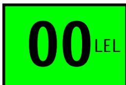
La pantalla color verde muestra una ausencia de fuga de gas. Condición normal.
