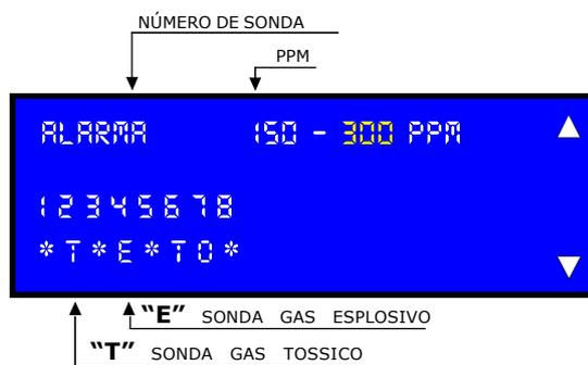
**LOS UMBRALES DE ALARMA PARA GASES EXPLOSIVO SE DIVIDEN DE LA SIGUIENTE MANERA:**
