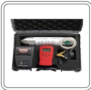
**Prueba funcional con GAS precalibrado y tester de control.**
