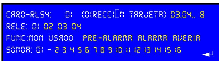
A la centralita se pueden conectar **HASTA A UN MÁXIMO DE 16 TARJETAS DE EXPANSIÓN RELÉ CARD-RLS4**. En cada tarjeta están presentes **4 relés** los cuales pueden ser asociados a la sonda deseada. **Con un máximo de 64 relés.**
