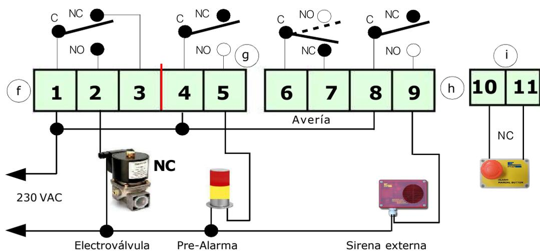
Conexión eléctrica Tarjeta de expansión
