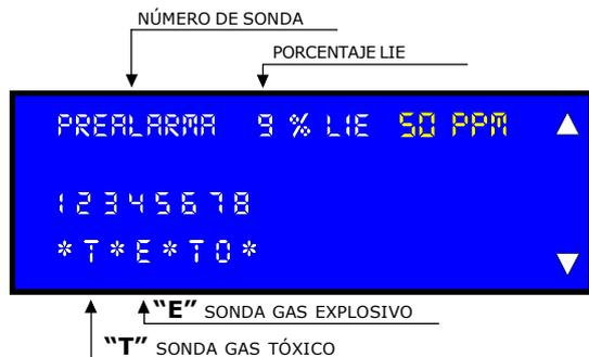
Presione los botones **"DX"** y **"SX"** y pasa a la sonda deseada (en el dibujo, el 4).
